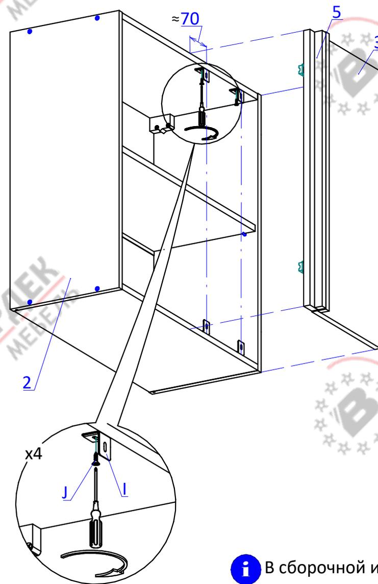
**i** В сборочной инструкции указана сборка левого модуля. При сборке правого модуля стенка передняя и фасад Угол (поз.3+5) ставится на противоположную сторону.
